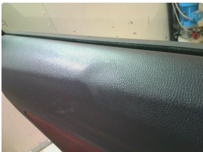
2.1 Skadet/merker etter utstyr
