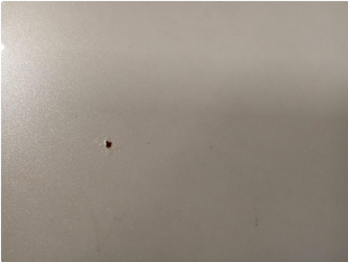
1.1 Steinsprut med rust
