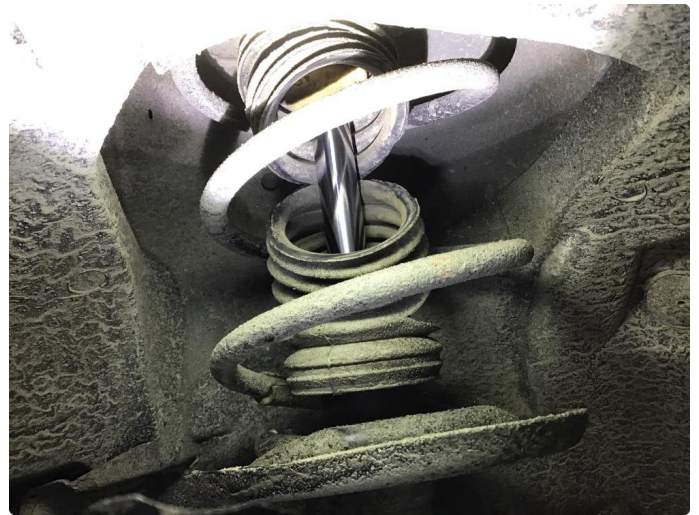
3.1 Støvmansjett, sprukket og løs. Blir fjernet løse deler og montert bedre.
