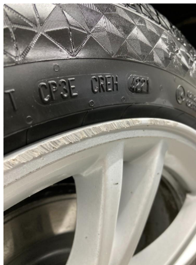
1.2 Kantkjørt vinterfelg - h.bak
