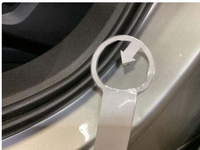
1.5 Små ubetydelige bulker i døråpning/dør venstre side foran.
