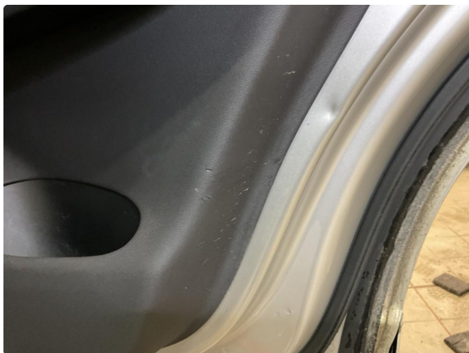
1.6 Liten bulk på innside av høyre bakdør.
