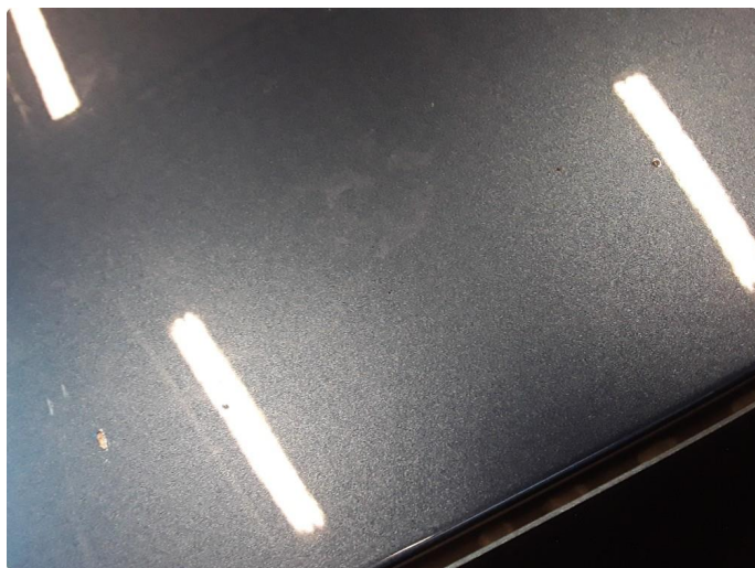
1.8 Steinsprut med korrosjon.
