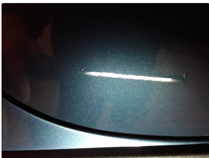
1.4 Steinsprut med korrosjon.
