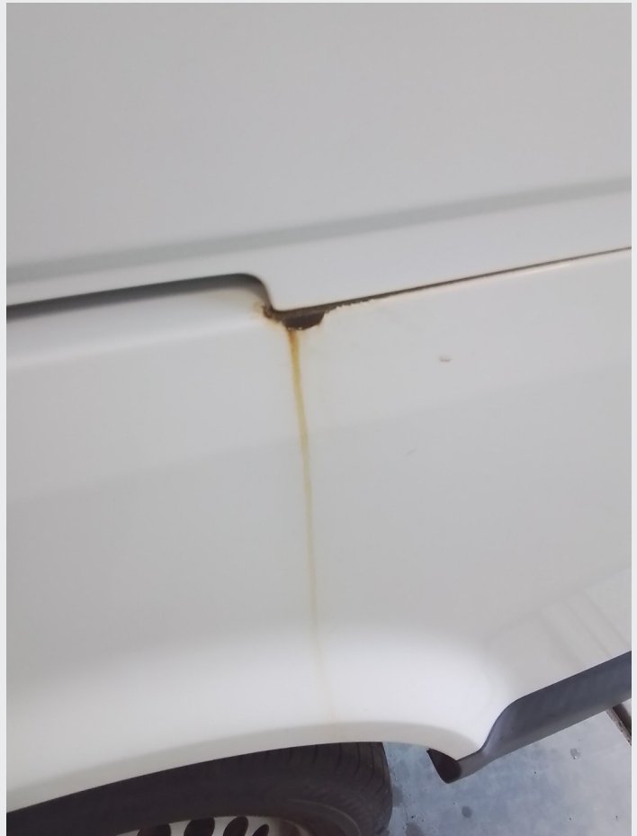
2.7 Rust ved skinne til skyvedør vb
