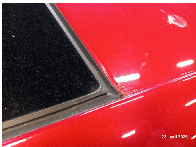
1.5 Litt korrosjon i bakre hjørne av glasstak
