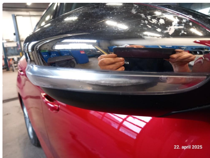
2.1 Sprekk i blinklys lykt høyre sidespeil
