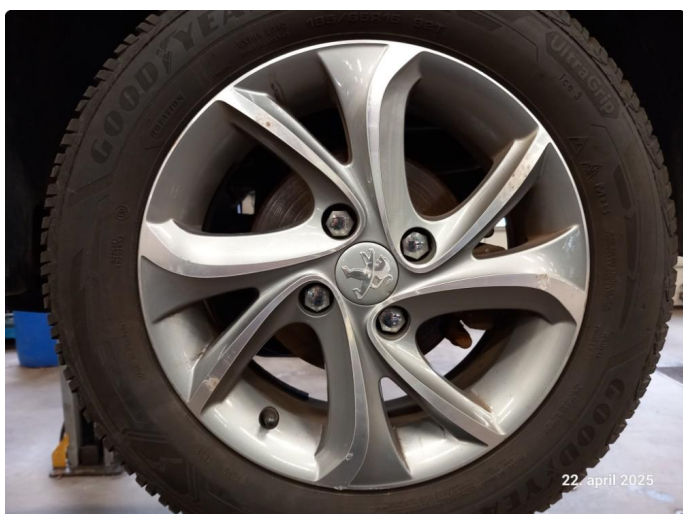
1.4 Påbegynnende oksidering på vinterhjul
