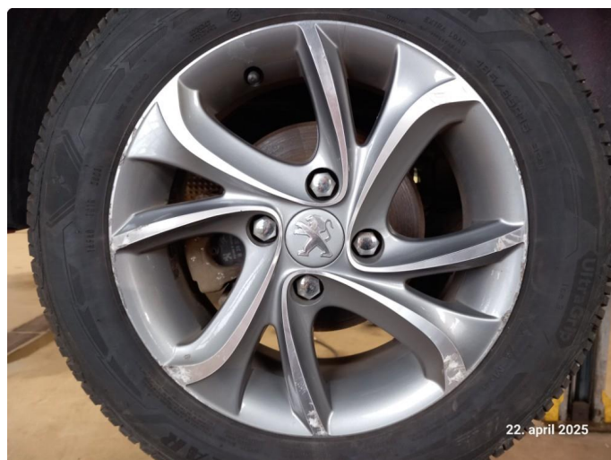
1.4 Påbegynnende oksidering på vinterhjul
