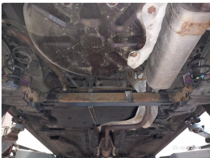
1.1 Noe overflaterust på bakaksling og fremre travers
