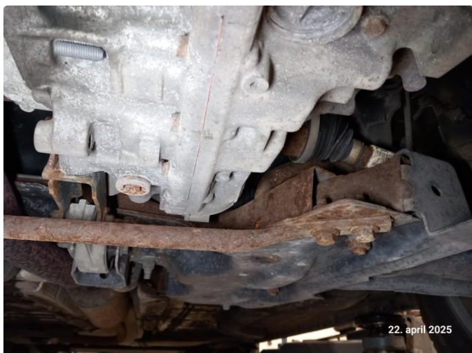
1.1 Noe overflaterust på bakaksling og fremre travers
