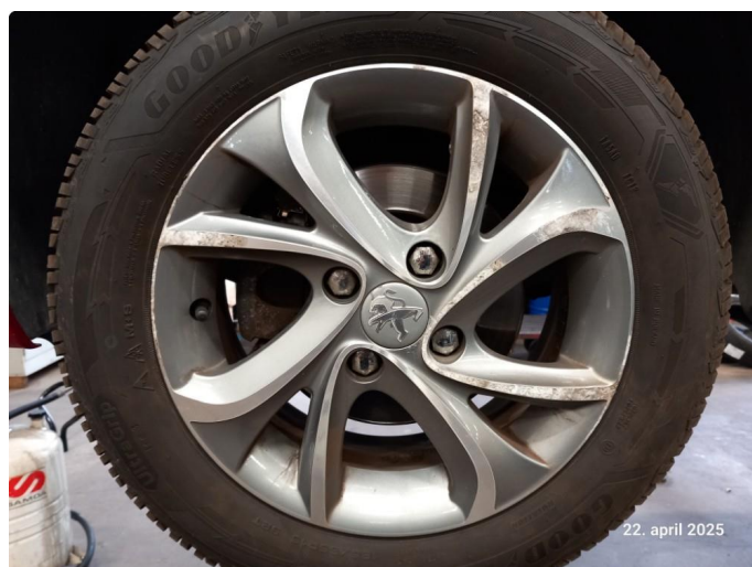
1.4 Påbegynnende oksidering på vinterhjul
