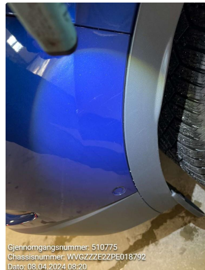
1.1 Ripe førerdør over til skjerm og panser.
