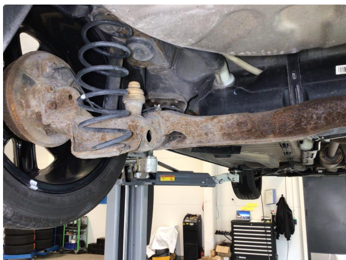
3.1 Overflaterust i bakstilling, ingen tiltak kreves
