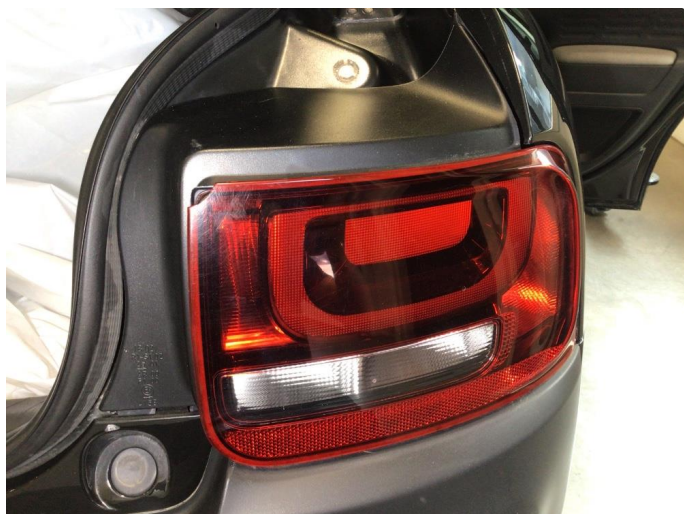
2.1 Krakelering i plast på begge baklykter
