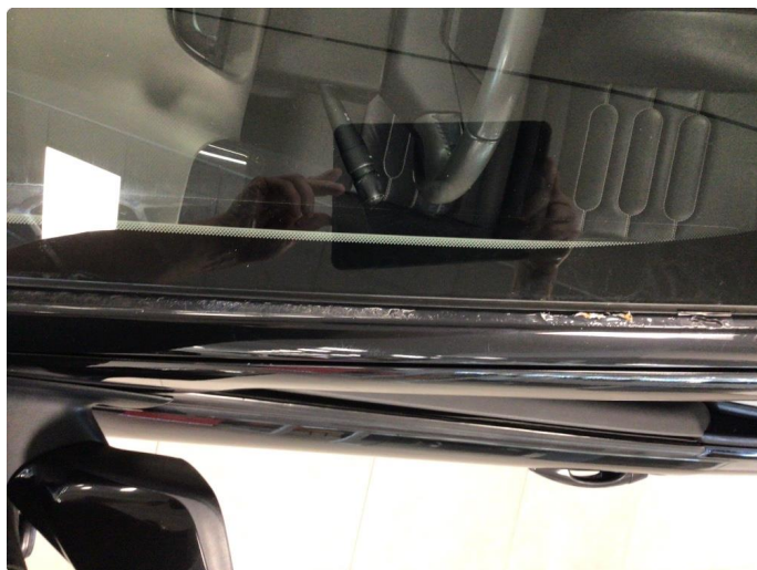
1.3 Korrosjon ved A - stolpe ved frontvindu førerside, dette blir utbedret med smart repair
