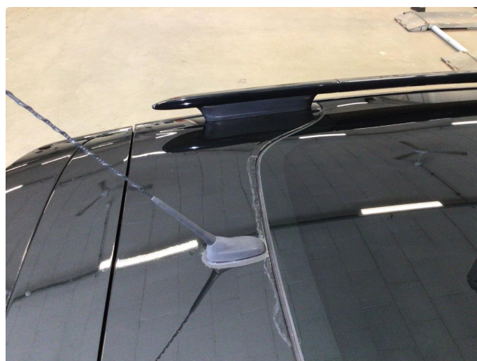
1.2 Korrosjon på tak er utbedret med pensellakk
