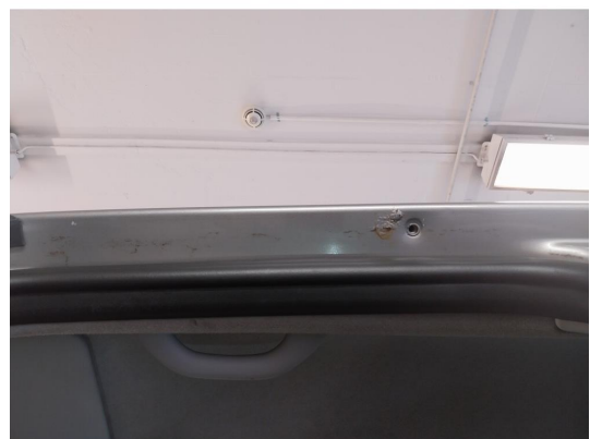
2.21 Rust på takk
