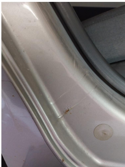
2.18 Riper med rust ved innsteg v.s bak
