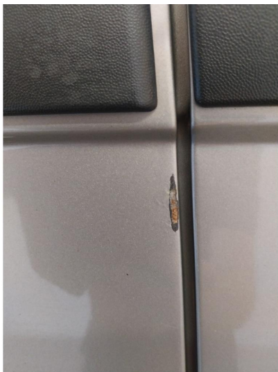
2.8 Steinsprut med rust og riper på bakdør h.s
