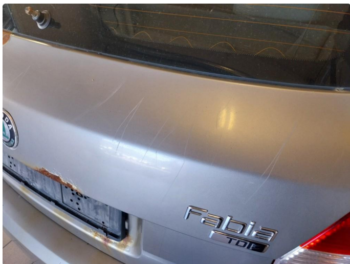
2.10 Rust på bakluke
