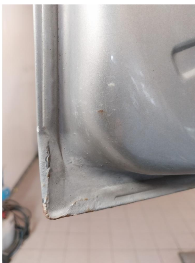
2.4 Flere Steinsprut med rust og rust i fals ved framdør v.s
