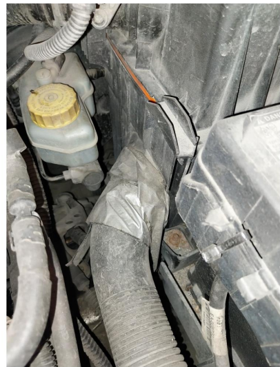
4.3 Luftslange skdet ved luftfilter
