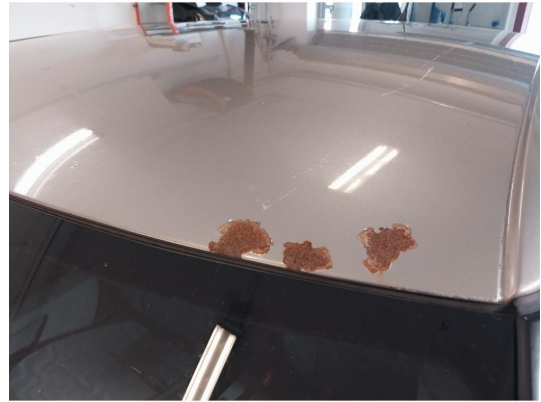
2.21 Rust på takk
