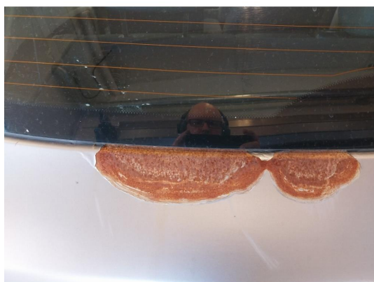
2.10 Rust på bakluke
