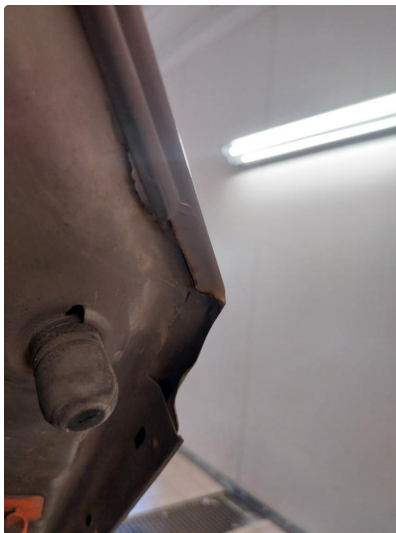
2.2 Flere Steinsprut med rust på panser og rust i fals
