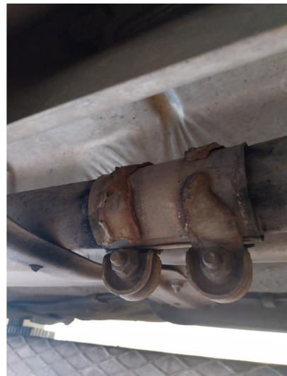
4.1 Eksoslekkasje og løse forbindelse ved eksosrør midt
