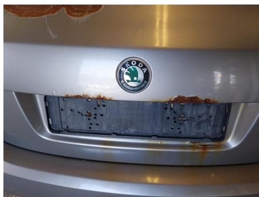
2.10 Rust på bakluke
