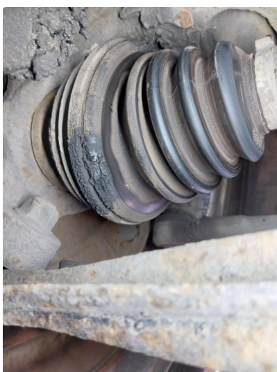
7.1 Begge Ytre Drivakselmansjet foran er skadet
