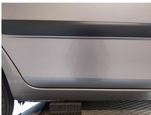
2.8 Steinsprut med rust og riper på bakdør h.s
