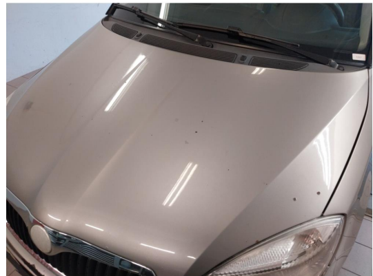
2.2 Flere Steinsprut med rust på panser og rust i fals
