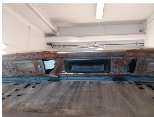
2.10 Rust på bakluke
