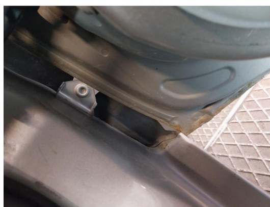
2.9 Steinsprut med rust på h.s framdør
