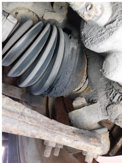
7.1 Begge Ytre Drivakselmansjet foran er skadet
