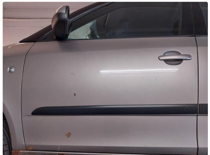
2.4 Flere Steinsprut med rust og rust i fals ved framdør v.s
