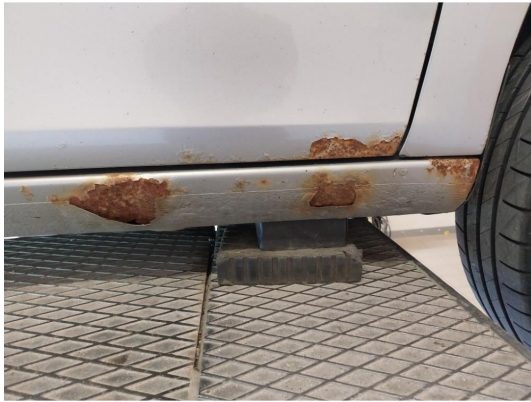
2.23 Rutsnt kanal ved begge sider
