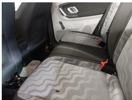
8.3 Skade på setetrekk v.s bak
