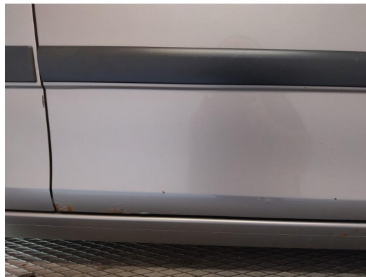
2.9 Steinsprut med rust på h.s framdør
