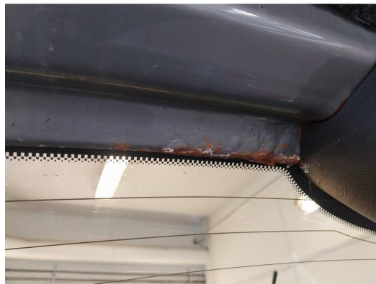
2.10 Rust på bakluke
