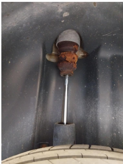
5.1 Mangler støvmansjett på begge demper bak
