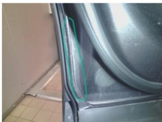
1.4 Rust i fals
