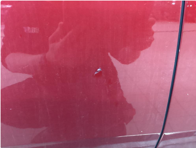
1.1 Ripe ned til grunning
