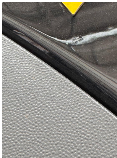
1.2 Liten steinsprut med korrosjon.
