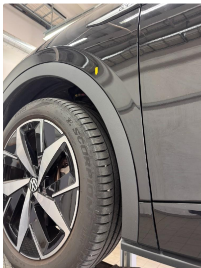
1.2 Liten steinsprut med korrosjon.
