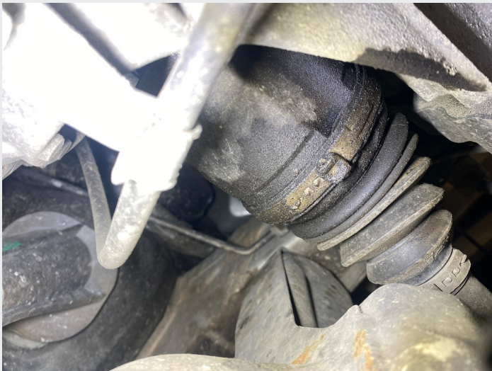
8.4 Legger merke til en liten svetting drivaksel indre venstre.
