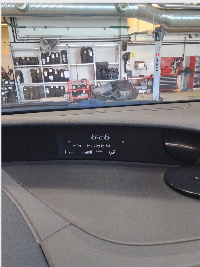
4.2 Display lyser ikke som det skal
