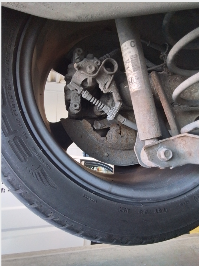
9.7 Bremseskjold bs bak opprustet
