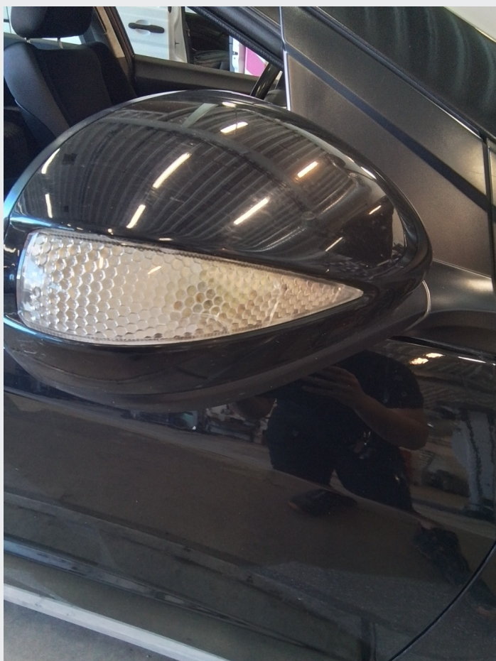
3.4 Sprekk i blinklysglass på speil høyre
