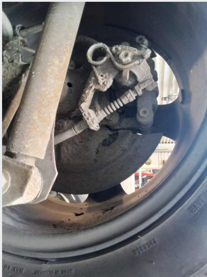
9.7 Bremseskjold bs bak opprustet
