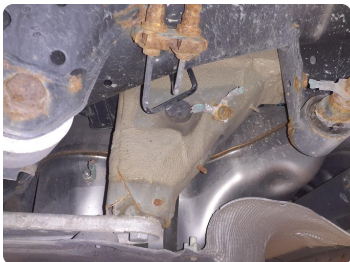
2.2 Øvrige feil Jording bak ved differensial defekt
