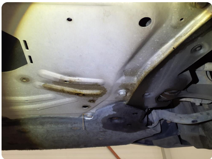
3.1 Øvrige feil Lekkasje fra motor/gir
