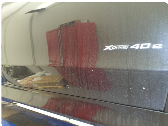
2.4 Steinsprut med rust
