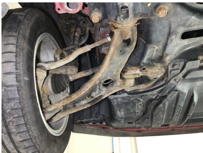
4.1 Overflate rust under bil
