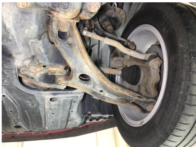
4.1 Overflate rust under bil
