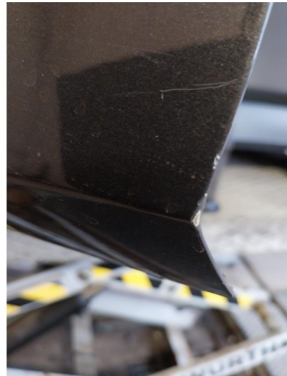
1.1 Steinsprut med rust
