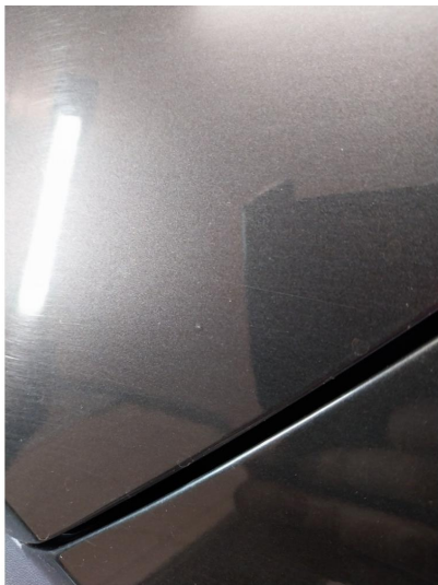
1.2 Bulk med lakkskade
