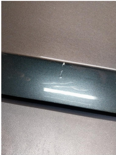
1.1 Steinsprut med rust
