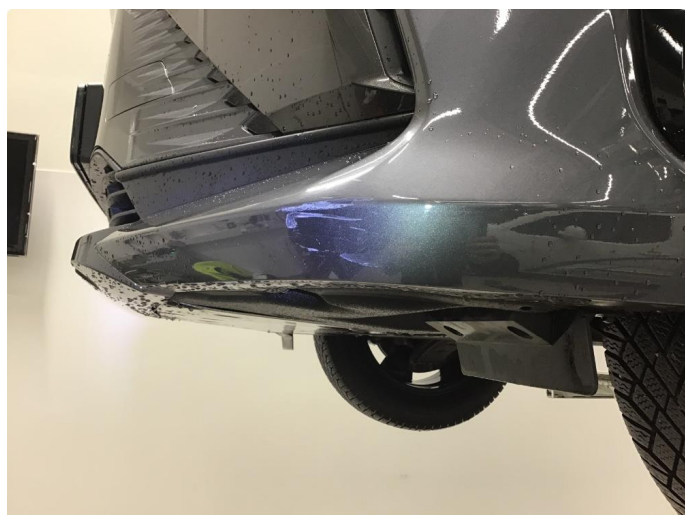
1.3 Ripe(r) ned til grunning
