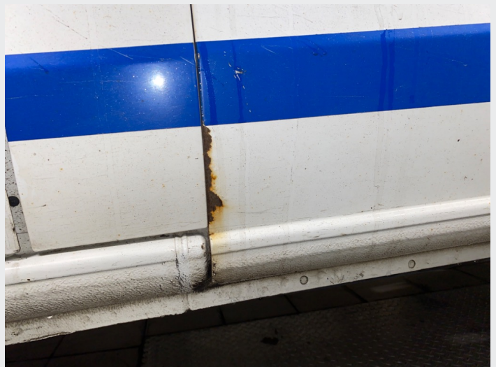
2.5 Rust venstre skyvedør
