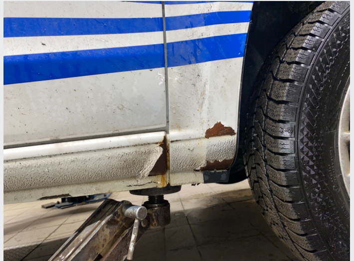
2.7 Rust høyre forskjerm
