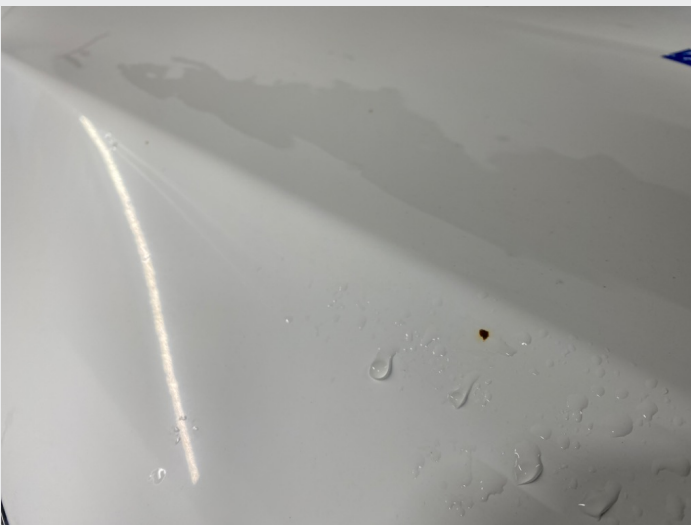
2.3 Steinsprut panser, rustet
