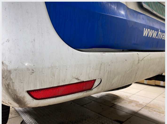
2.8 Bakfanger skadet venstre side
