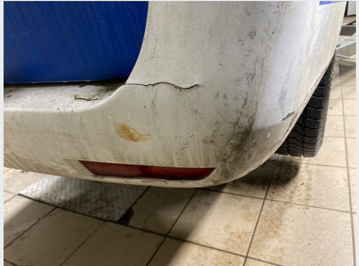
2.8 Bakfanger skadet høyre side
