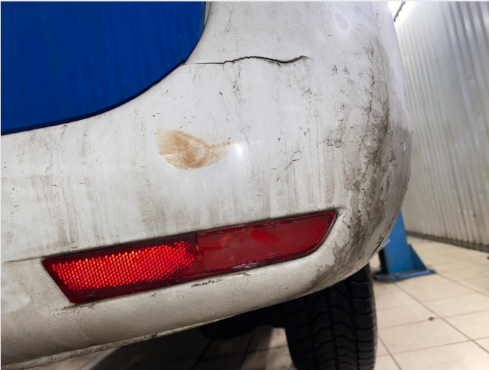
2.8 Bakfanger skadet høyre side
