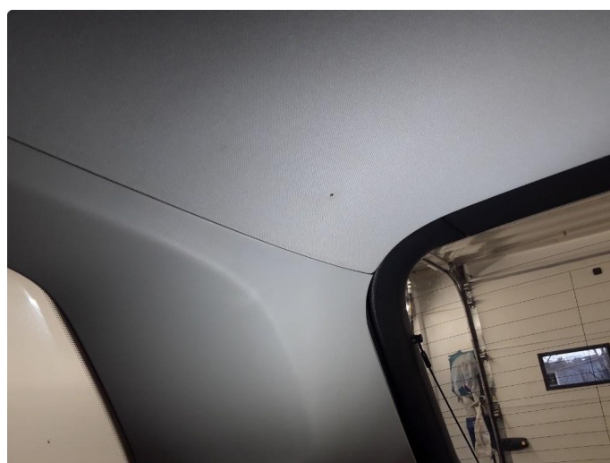
3.1 Et lite rift/hull i taktrekket bak i bilen. Normal bruksslitasje
