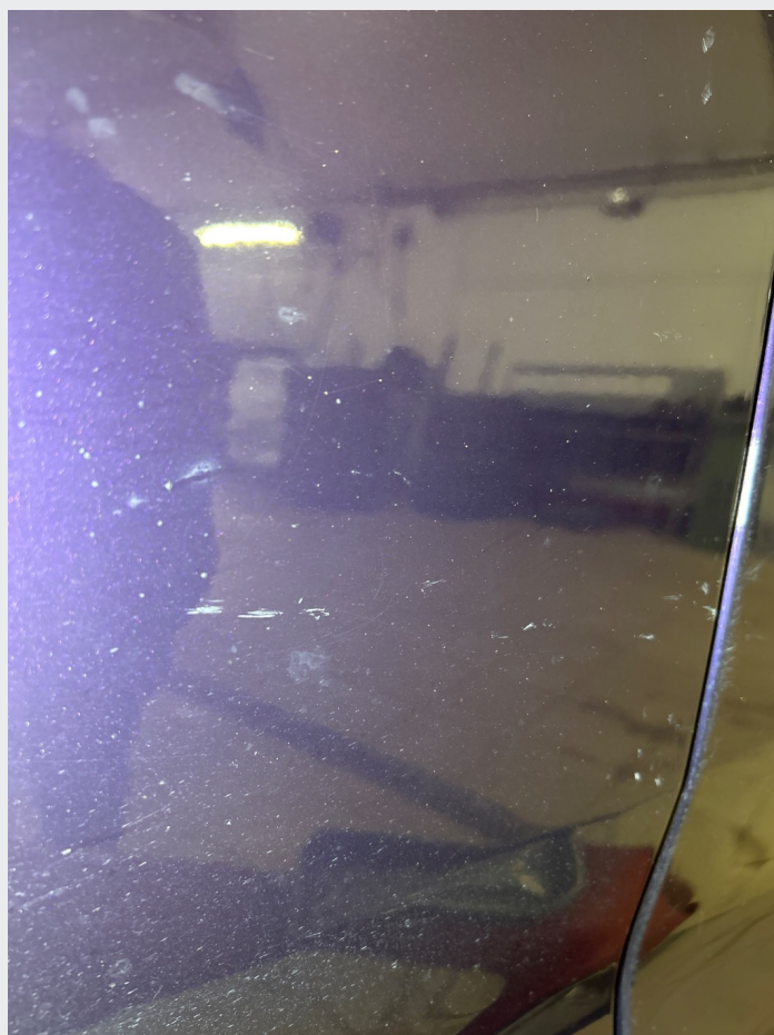
2.5 Lakkflass på førerdør, begynt å ruste + riper
