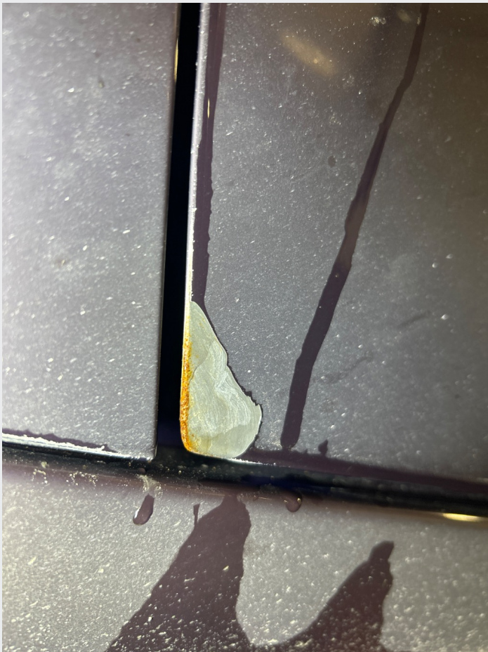
2.5 Lakkflass på førerdør, begynt å ruste + riper
