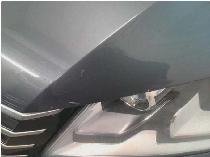
1.1 Noe steinsprut med rust
