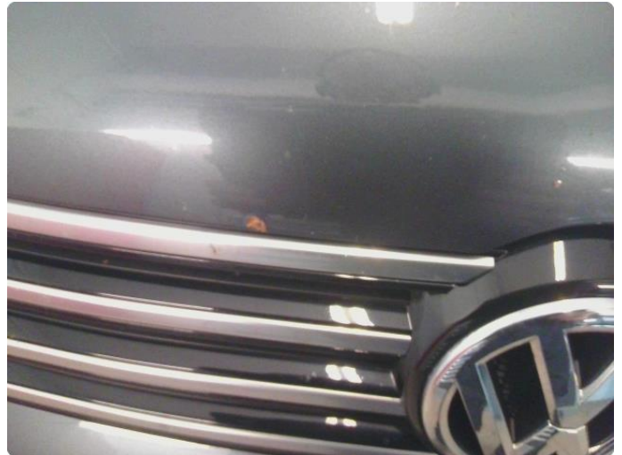
1.1 Noe steinsprut med rust
