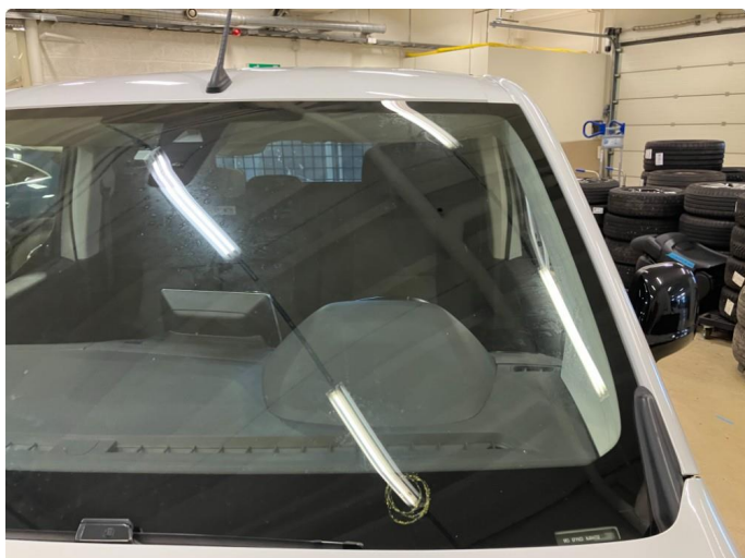
1.1 Steinspruten er reparert
