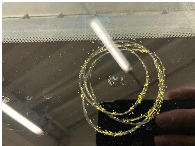
1.1 Steinspruten er reparert
