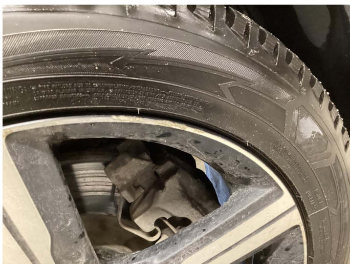
1.3 Kantkjørt felg, Normal slitasje ihht alder og km
