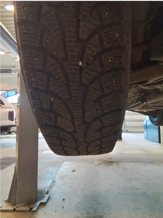
2.17 Mangler pigger på piggdekk
