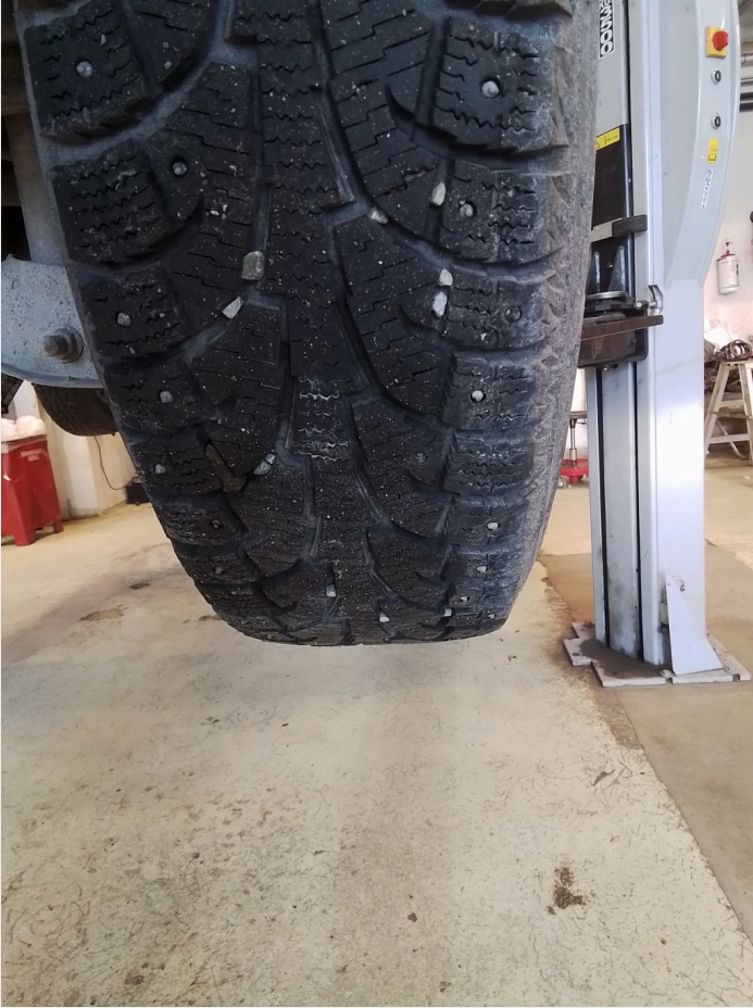
2.17 Mangler pigger på piggdekk
