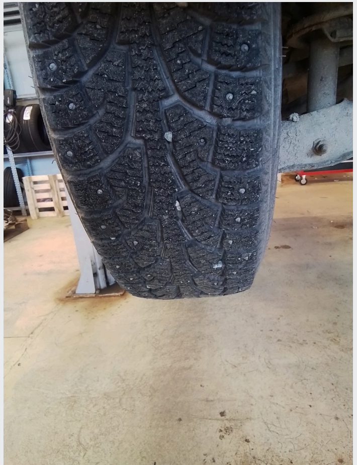
2.17 Mangler pigger på piggdekk
