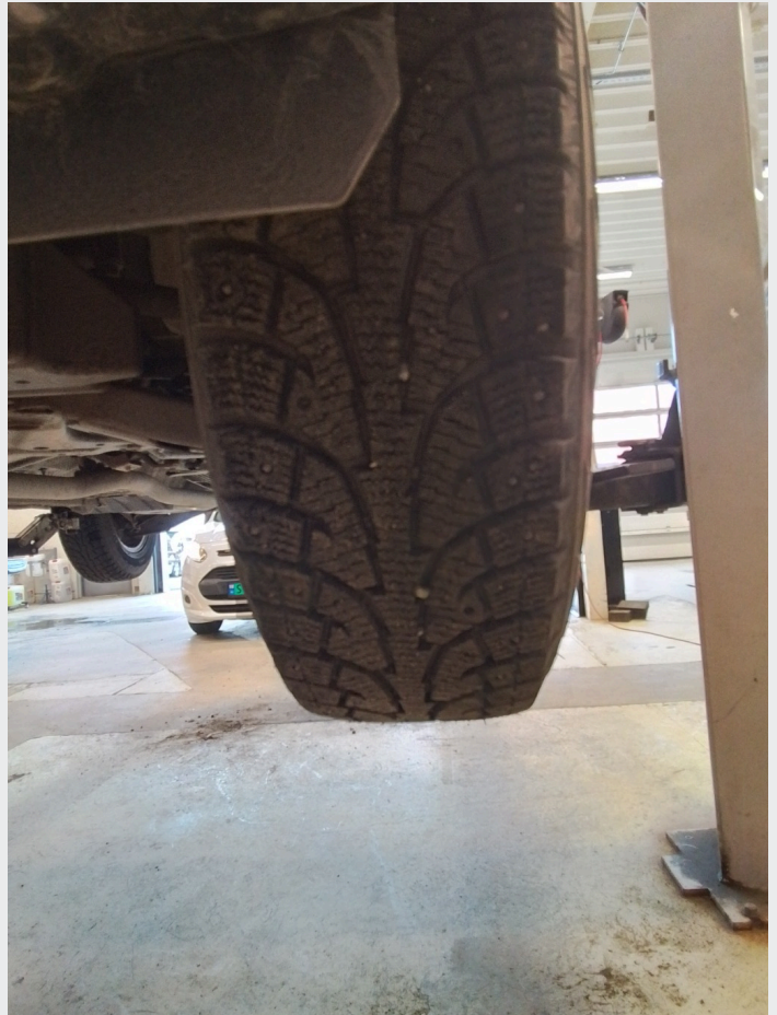
2.17 Mangler pigger på piggdekk
