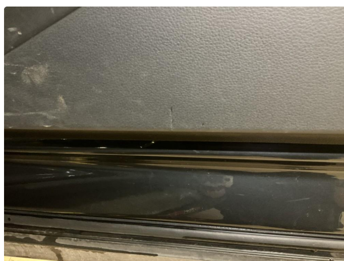
2.1 Merke på dørtrekk høyre foran
