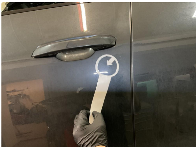
1.1 Liten parkeringsbult på førerdør
