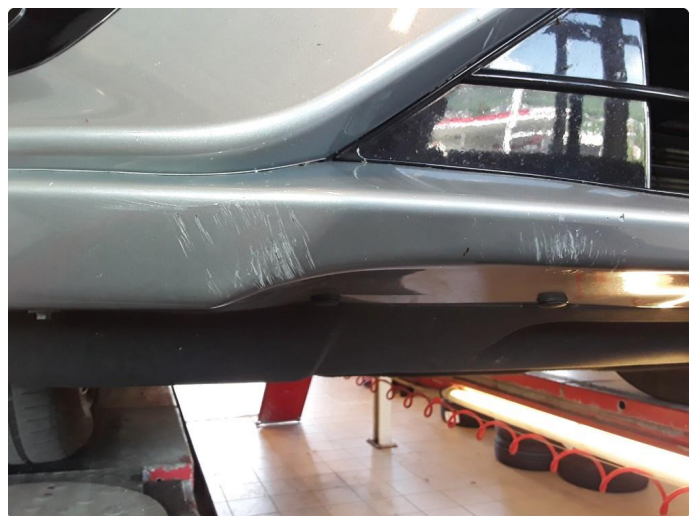
1.4 Liten bulk høyre foran.
