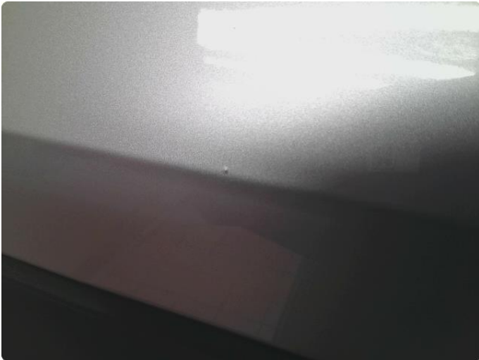
1.1 Steinsprut med zinkboble v.s bakdør ned
