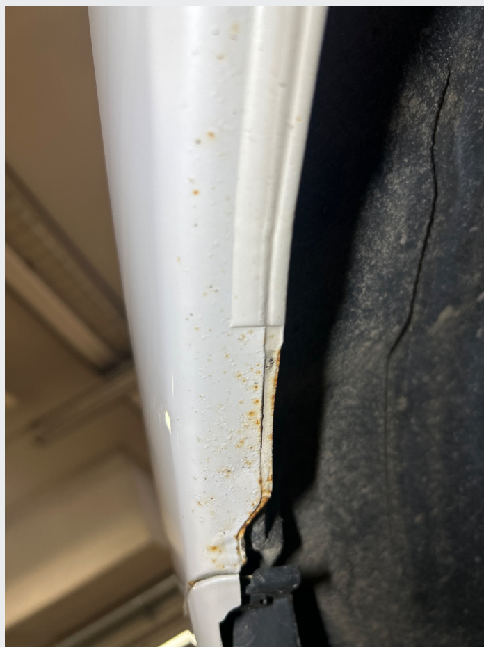
2.14 Noe rust rundt om i karosseri
