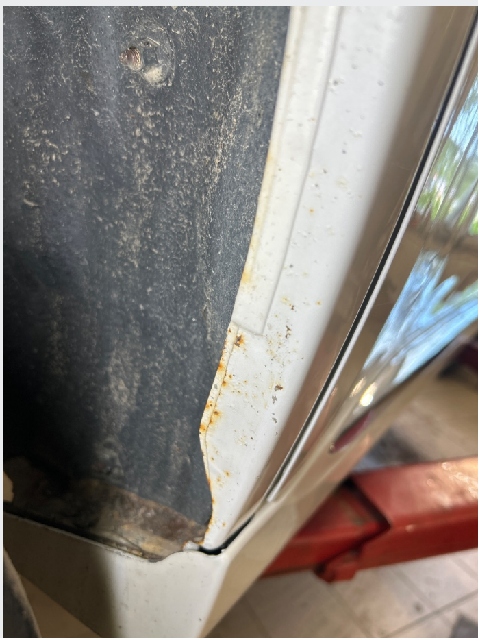
2.14 Noe rust rundt om i karosseri
