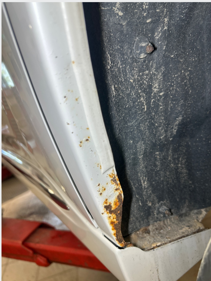
2.14 Noe rust rundt om i karosseri
