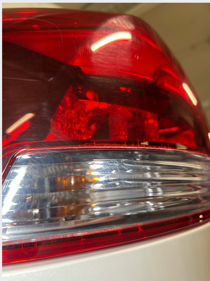
3.2 Sprekk i ytre venstre baklykt
