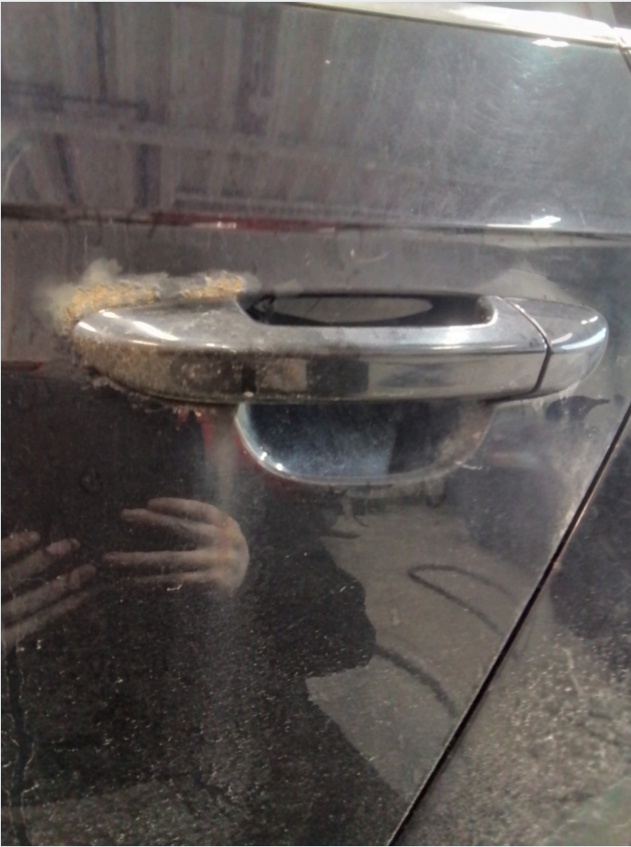
2.5 Rust venstre bakdør
