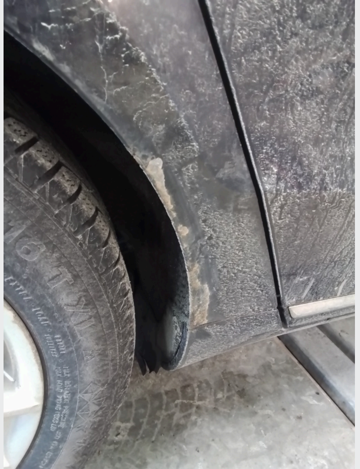
2.7 Rust høyre bakskjerm
