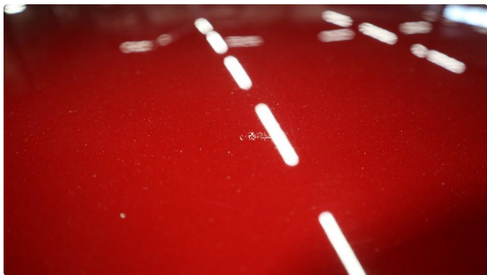
1.3 Steinsprut med rust
