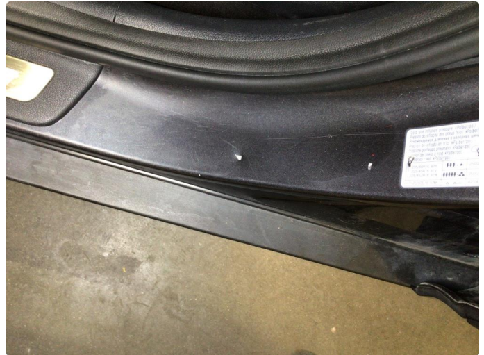
1.1 Noen små hakk/riper i døråpning ved høyre bakdør og venstre framdør blir utbedret med smart repair/pensellakk
