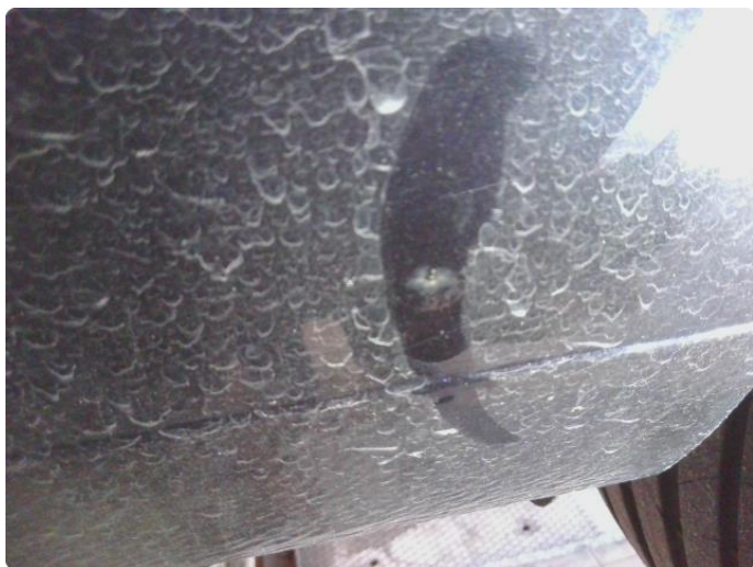
1.7 Steinsprut med rust
