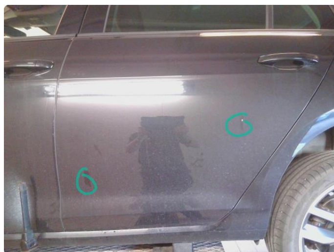
1.3 Steinsprut med rust
