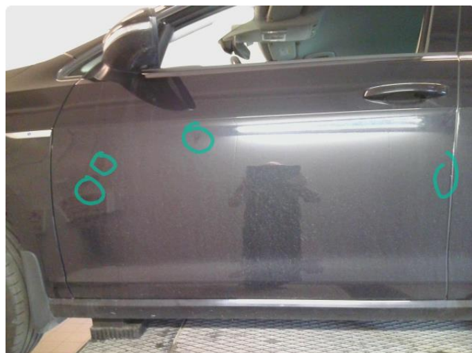
1.2 Steinsprut med rust
