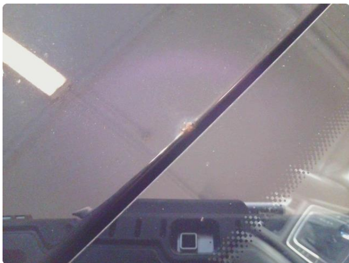
1.14 Steinsprut med rust
