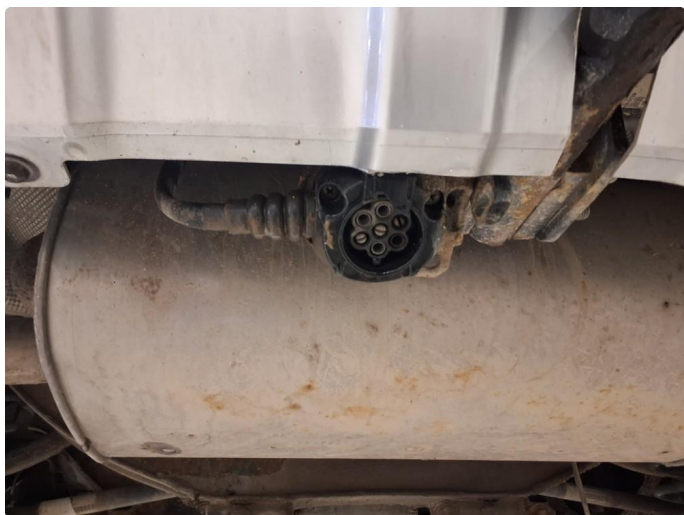
2.3 Tilhengerkontakt- innfesting skadet
