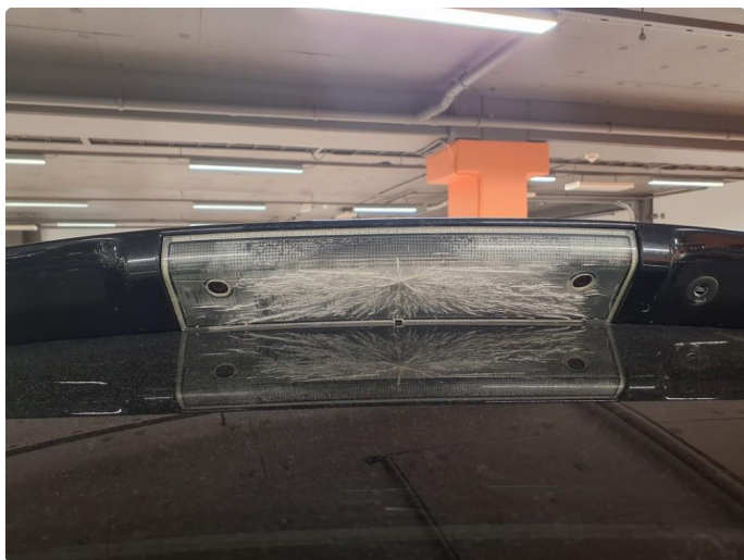
3.3 Defekt / sprukket glass
