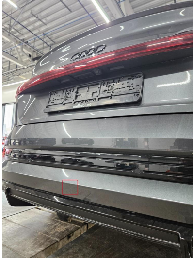
1.1 Noe skrubbermerker i plastfanger, nedre bak, penslet m/lakk, anmerket
