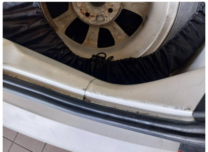
1.8 Lastekant er slitt
