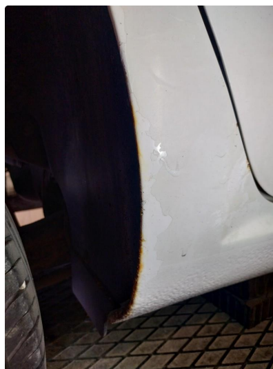
1.10 Flere rustbobler og rust ved bakskjerm h.s
