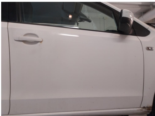
1.6 Rust rund dørhåndtak og steinsprut med rust på h.s framdør
