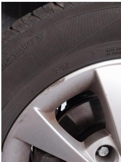
1.13 Kantkjørt v.s foran
