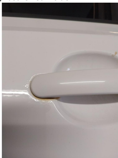
1.3 Rust rund dørhåndtak og noen steinsprut med rust på framdør v.s
