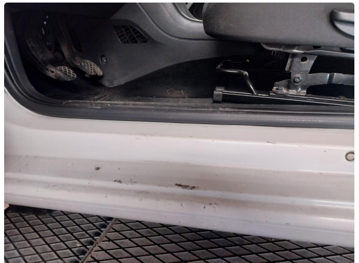
1.14 Slitt innsteg v.s foran
