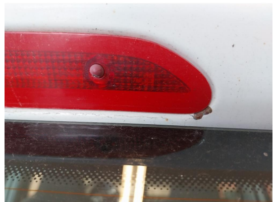
1.7 Utbedret lakkskade med feil lakk, Lakk er matt, rust ved bakluke
