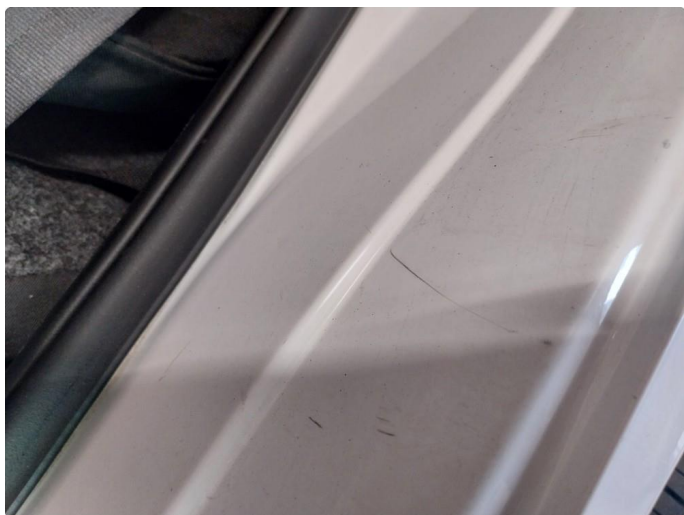
1.15 Riper ved døråpning v.s bak
