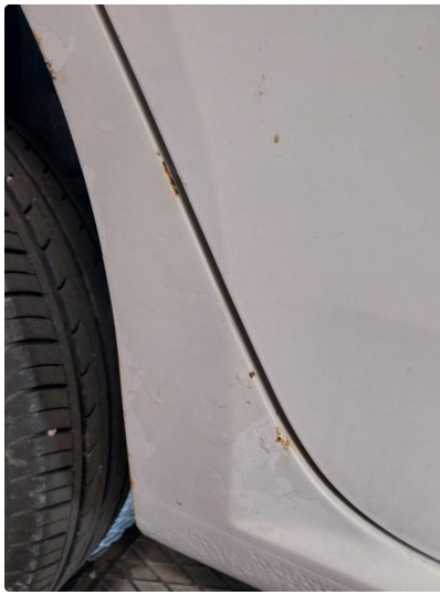
1.10 Flere rustbobler og rust ved bakskjerm h.s
