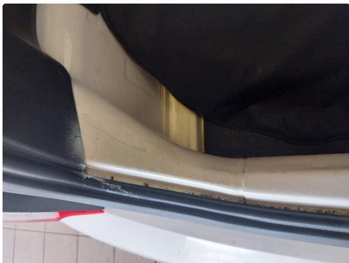
1.8 Lastekant er slitt
