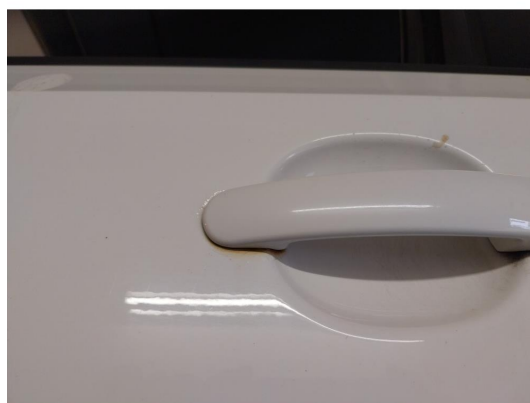
1.3 Rust rund dørhåndtak og noen steinsprut med rust på framdør v.s
