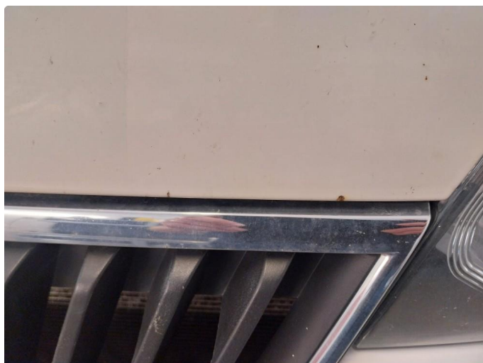
1.2 Flere steinsprut med rust, utbedret lakk med feil farge, rustne ved inside
