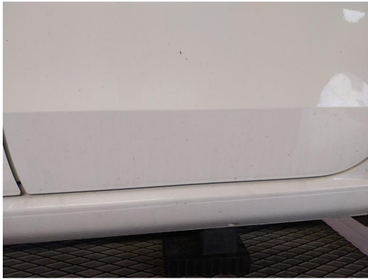
1.4 Noen Steinsprut med rust ned ved bakdør v.s
