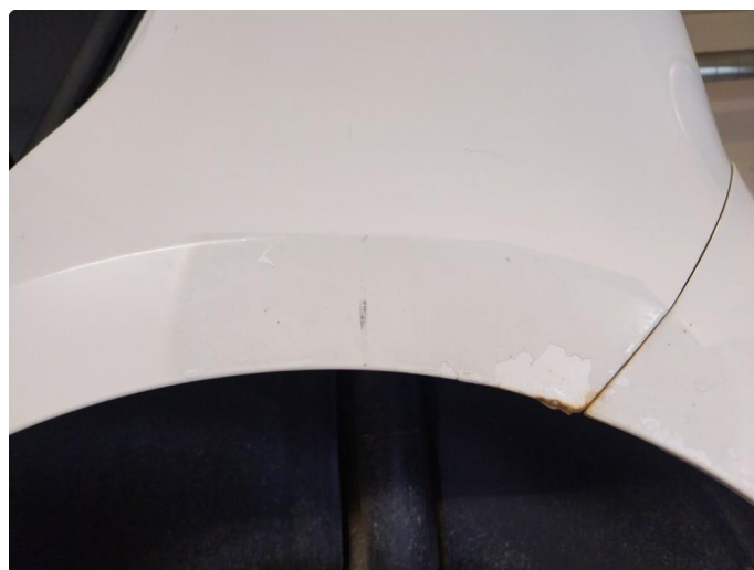
1.10 Flere rustbobler og rust ved bakskjerm h.s
