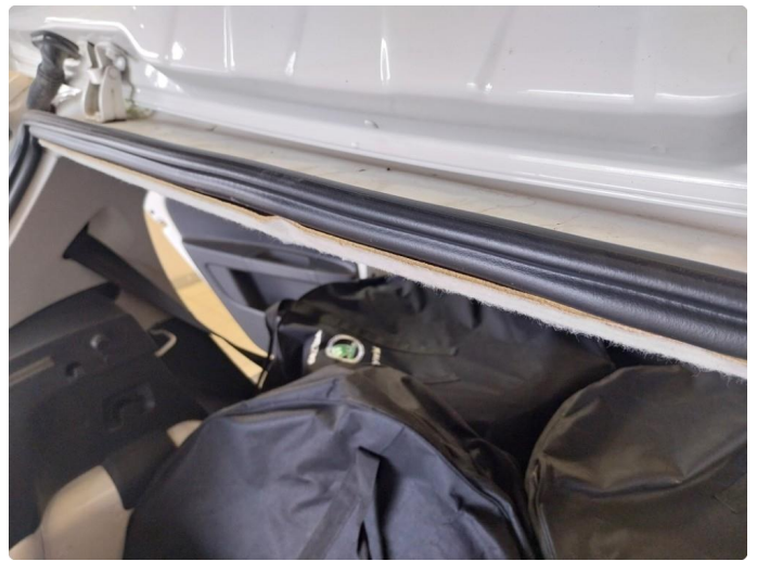
5.1 Takktrekk sitter ikke på plass
