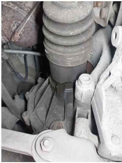
4.1 Svetting mellom fordelingskasse og Drivakksel h.s
