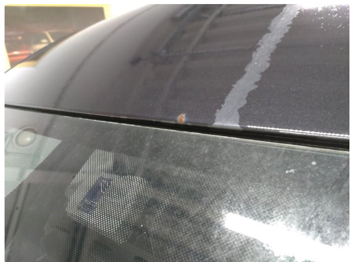
2.4 Steinsprut med rust
