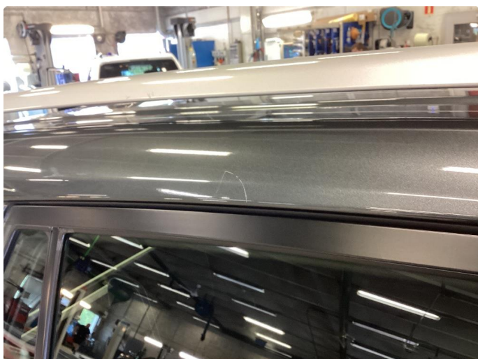
1.2 Ripe over høyre bakdør.
