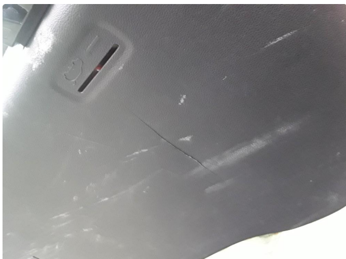
1.2 Noe skadet deksel på bakluke.
