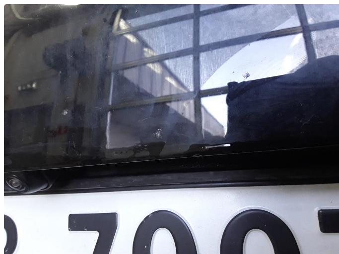
1.3 Steinsprut med korrosjon.
