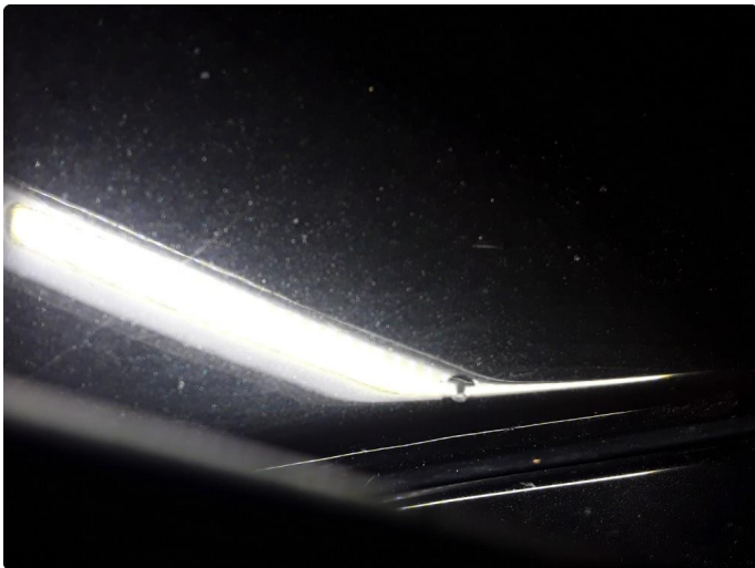
1.2 Liten steinsprut med korrosjon.
