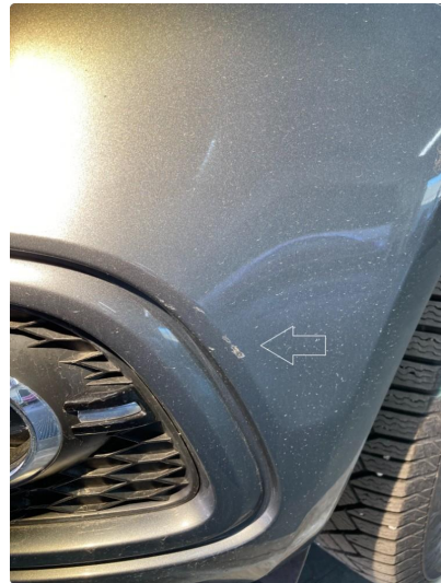
1.2 Noen små riper på venstre støtfangerhjørne foran (plastikk)
