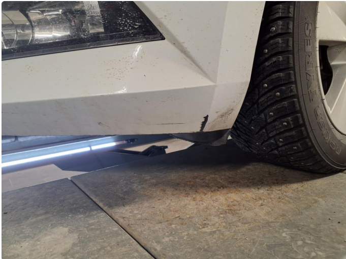
1.1 Ripe(r) ned til grunning
