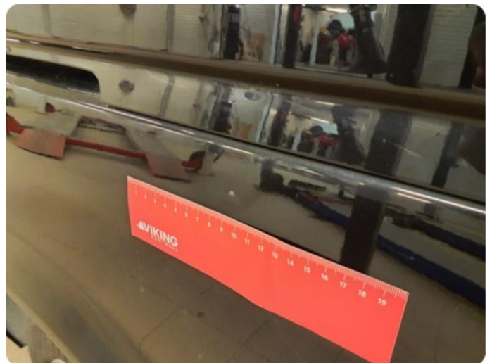
1.1 Generelt mye riper og småbulker, panser+dører+bakluke+skjermer
