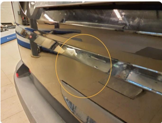
1.1 Generelt mye riper og småbulker, panser+dører+bakluke+skjermer
