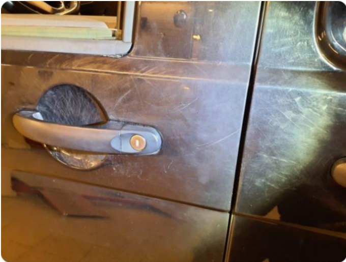
1.1 Generelt mye riper og småbulker, panser+dører+bakluke+skjermer
