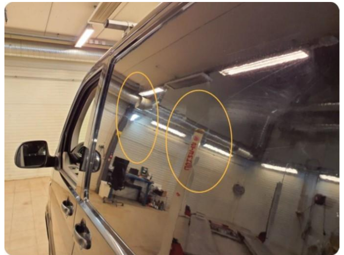
1.1 Generelt mye riper og småbulker, panser+dører+bakluke+skjermer
