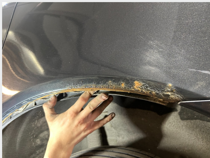
2.14 Rust i hjulbue venstre side bak
