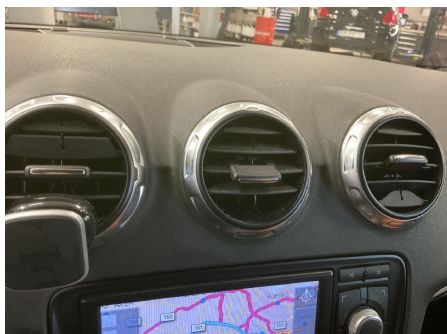
43. Varmeapparat / klimaanlegg (AC)
