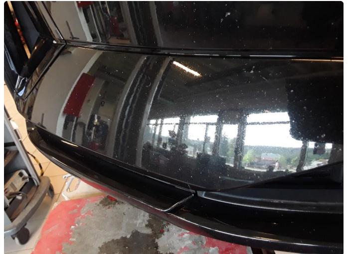
1.3 Noe steinsprut i front.
