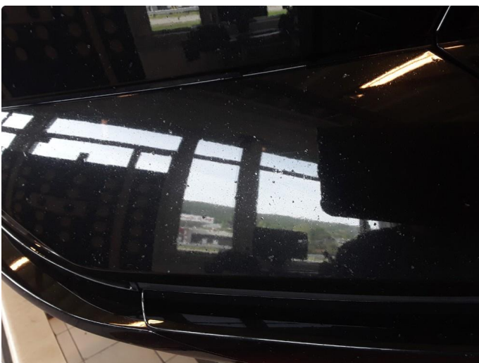
1.3 Noe steinsprut i front.
