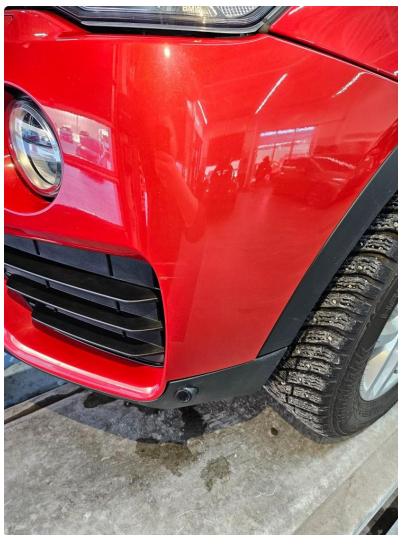
1.7 Div steinsprut/små lakkskader
