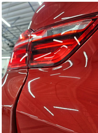
1.2 Div steinsprut/små lakkskader
