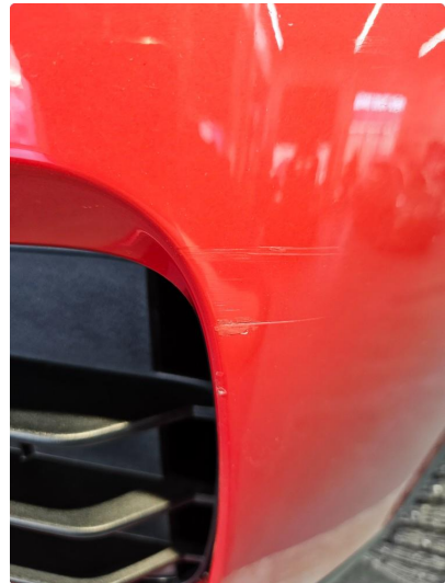
1.7 Div steinsprut/små lakkskader
