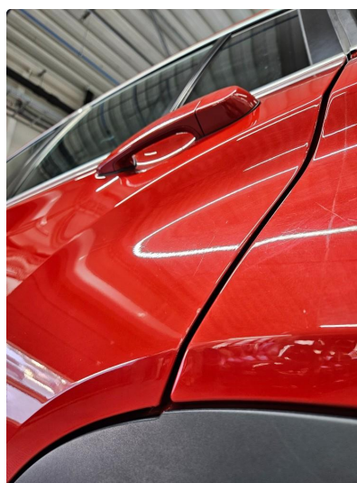
1.2 Div steinsprut/små lakkskader
