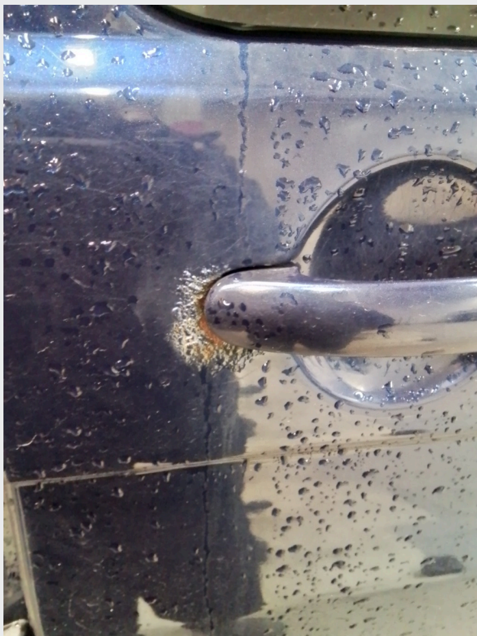
2.5 Rust venstre bakdør
